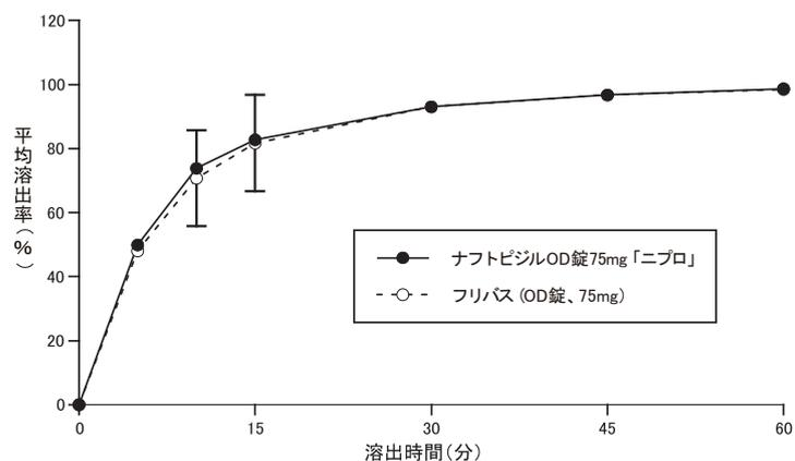
③試験液：pH6.8 回転数：50rpm
