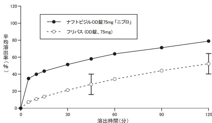
②試験液：pH4.0 回転数：50rpm
